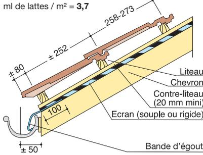
Le débord de la tuile est donné à titre indicatif, il doit être vérifié par rapport au type de gouttière utilisé. Le nez de la tuile doit être à l'axe de la gouttière.
