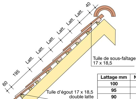
Le débord de la tuile est donné à titre indicatif, il doit être vérifié par rapport au type de gouttière utilisé. Le nez de la tuile doit être à l'axe de la gouttière.
