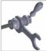
**▶** Insérez un tournevis dans l'anse du bouchon de terminaison pour le bloquer.
