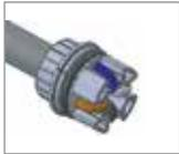
**▶** Insérez le câble dans le corps du bouchon de terminaison afin que les quatre fils conducteurs arrivent chacun sur un côté différent du séparateur interne.
