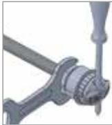
**▶** Recourbez les fils dans les creux du bouchon de terminaison et coupez-les à la longueur nécessaire.
