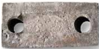
Perçage de 2 trous : 30 mm de diamètre
