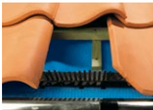
Latte de ventilation Garantit une entrée d'air continue à hauteur de la gouttière. Latte de ventilation avec peigne pour tuiles galbées et sans peigne pour tuiles plates ou faiblement galbées.
