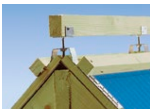
Support de latte faîtière ajustable Ce support de lattes est fabriqué en acier galvanisé. C'est un procédé efficace pour la fixation des lattes des faîtières et des arêtières.
