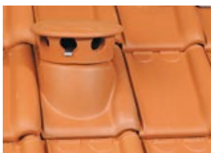
Module de connexion des tuiles à douille Raccord parfait entre la tuile à douille et la conduite d'évacuation. Ancrage solide du module au mitron en terre cuite à l'aide de 3 crochets en acier inoxydable. Applicable aux modèles Pottelberg suivants : Tuile Tempête 993, Vario 18, 401, 301, 451, Rustica et Plato.
