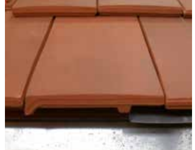
Tuile d'aération basse. Les renforts réhaussent le produit pour assurer la ventilation : 150 cm 2 au ml.
