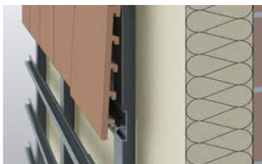
4 Mise en place des bardeaux Argelite®
