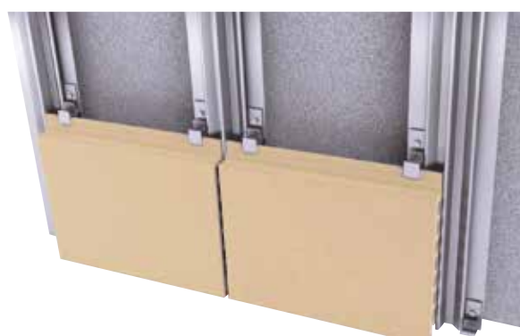
Montage du 1 er rang des bardeaux
