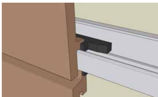
5 Insertion de la cale de stabilisation EPDM simple
