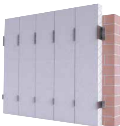
Mise en place de l'isolant
