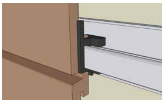
5 Insertion de la cale de stabilisation EPDM double
