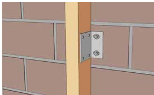
1 Montage de l'ossature primaire
